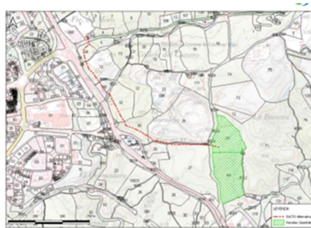
Figura 6. Trazado del ducto de evacuación del biometano desde la planta hasta el entronque de Enagás sobre parcelas catastrales. Fuente: Enagás.
